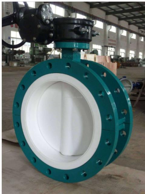
闸截止蝶阀结构简单、体积小、重量轻，只由少数几个零件组成。而且只需旋转90°即可快速启闭，操作简单，同时该阀门具有良好的流体控制特性。闸截止蝶阀处于完全开启位置时，蝶板厚度是介质流经阀体时单一的阻力，因此通过该阀门所产生的压力降很小，故具有较好的流量控制特性。闸截止蝶阀有弹密封和金属的密封两种密封型式。弹性密封阀门，密封圈可以镶嵌在阀体上或附在蝶板周边。采用金属密封的阀门一般比弹性密封的阀门寿命长，但很难做到完全密封。金属密封能适应较高的工作温度，弹性密封则具有受温度限制的缺陷。有的闸阀，阀杆螺母设在闸板上，手轮转动带动阀杆转动，而使闸板提升，这种阀门叫做旋转杆闸阀。电动闸截止蝶
